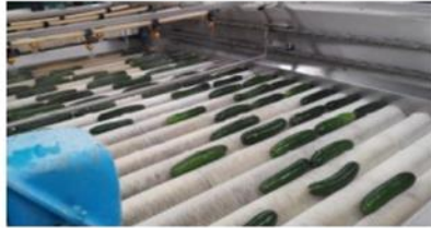
Figura 1. Lavado de fruta. Sistema de aspersión de agua.
